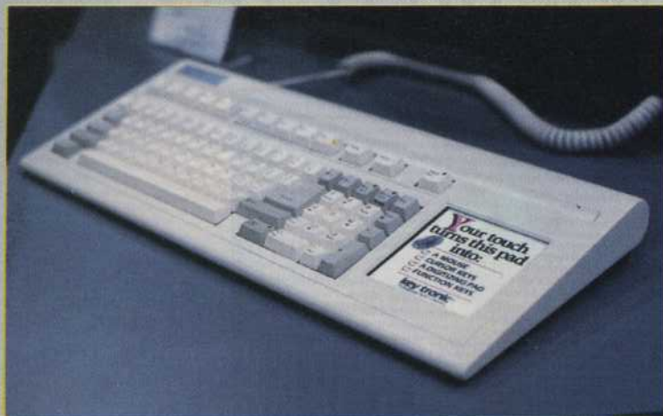
UNE NOUVELLE RACE DE CLAVIER pour les PC millésime 1987 ? Keytronic, spécialiste de l'Art, dote le clavier AT d'une zone sensitive réservée aux fonctions spécialisées (jusqu'à 36). Pour les adversaires de la souris.
